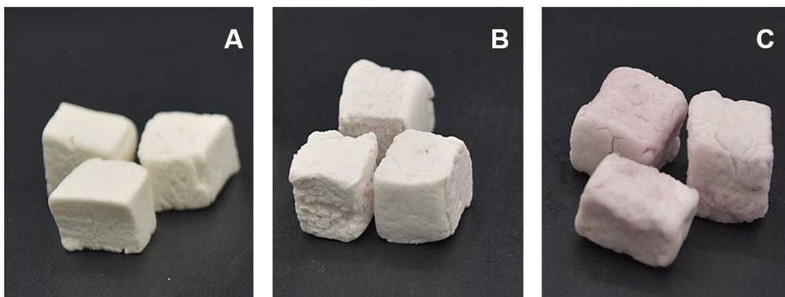
A: amostra controle (sem corante), B: amostra MSA (microcápsula 10% maltodextrina (extração solvente soro de leite ácido) e C: amostra SA extrato em pó (extração solvente soro de leite ácido) (sem maltodextrina).
