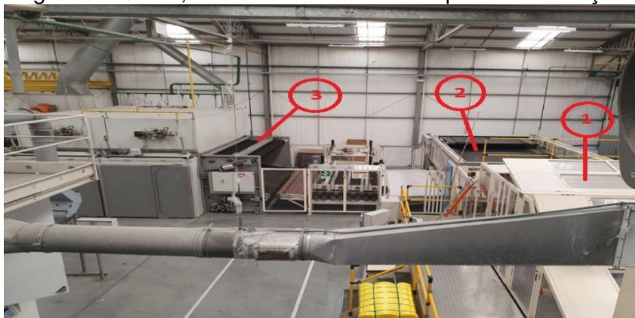
Nota: Carda (1); Dobrador de véus (2); Forno para a consolidação térmica (3).
