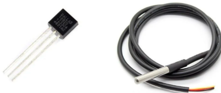
Figura 6.12 – Sensor de temperatura Dallas DS18B20 versão sem encapsulamento (esquerda) e versão com encapsulamento (direita)
