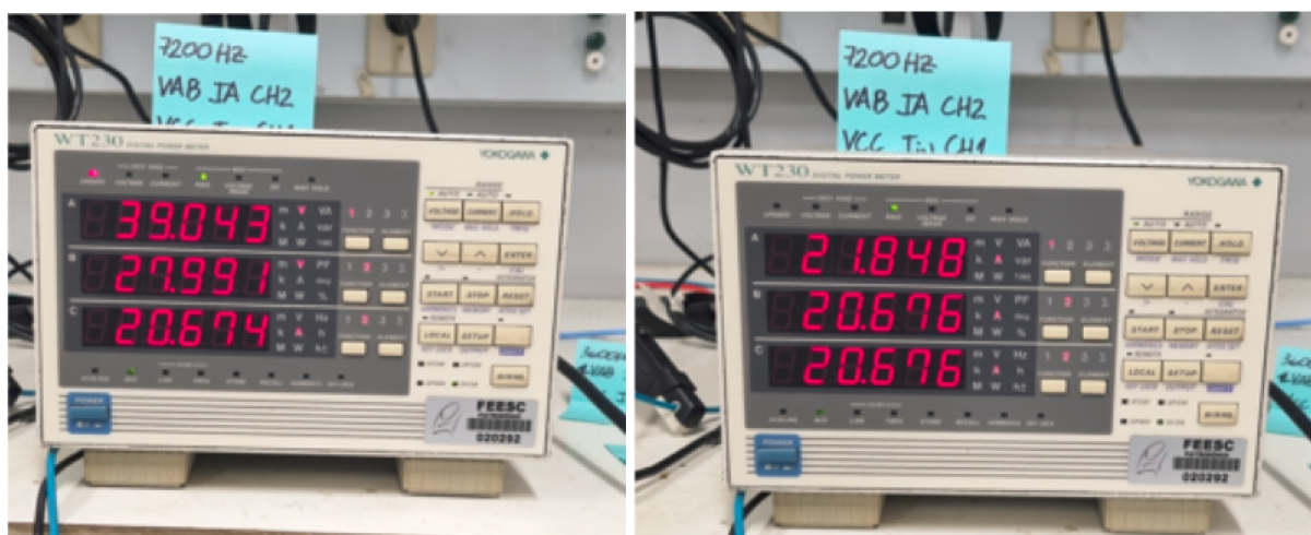
Figura 7.2 – Valores medidos para tensão e corrente na entrada e na saída do inversor
