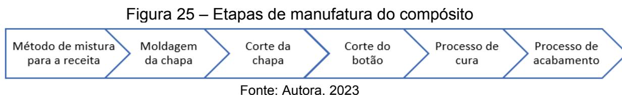
A manufatura dos botões ocorre conforme descrito na seção 3.2.2. Após a finalização das chapas produzidas, as mesmas são retiradas para o corte, seguem para a cura e depois inicia-se o processo de acabamento do botão.
