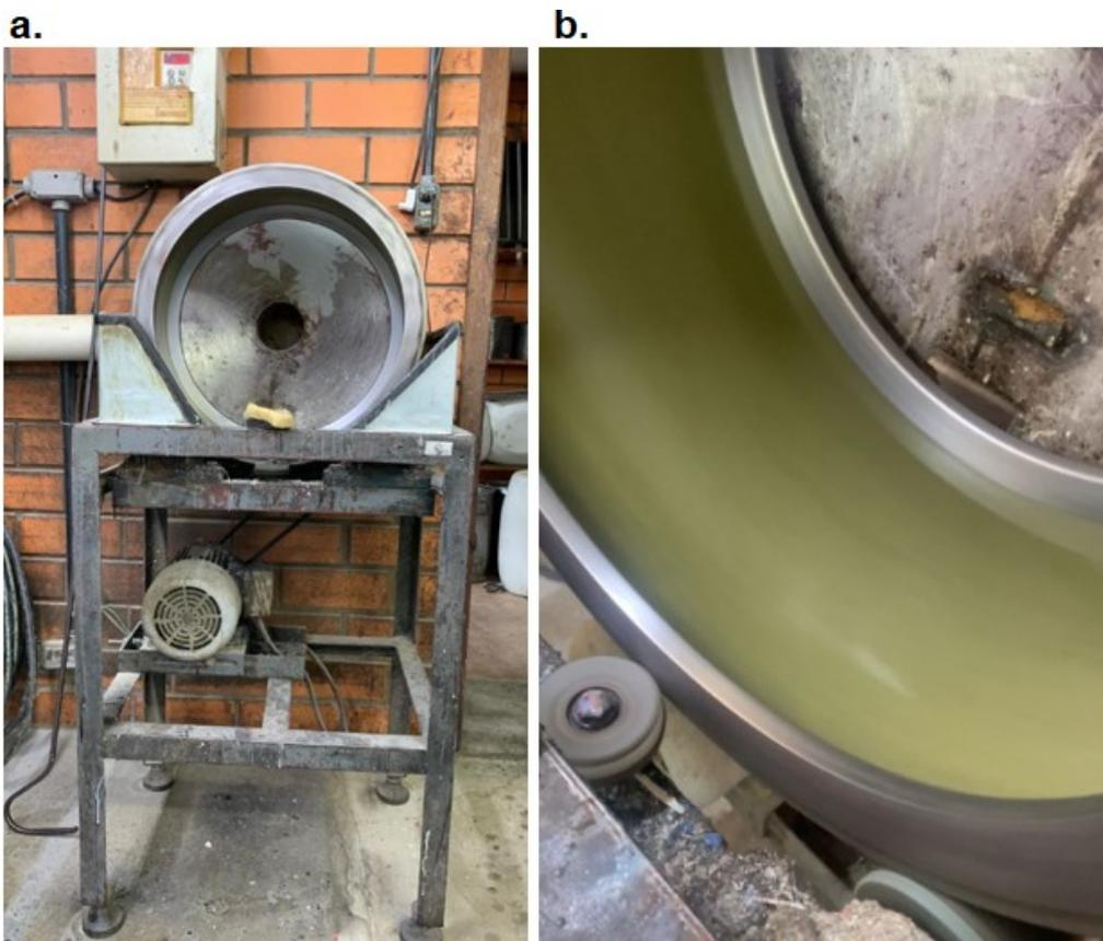
O tempo de preparação da resina de poliéster foi de 1 minuto e meio e para a resina de mamona foi de 3 minutos e meio. Dentro do cilindro, os tempos de rotação foram de 20 minutos para resina de poliéster e de 2 horas para a resina de mamona (por conta do seu tempo de cura). Quanto a cura do compósito foi de 2 horas para resina de poliéster e 15 dias para resina de mamona. Após a cura, o procedimento de corte dos corpos de prova foi realizado por meio de corte a laser (Figura 22).
