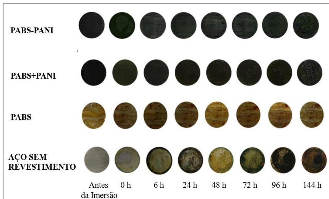
Figura 47 - Imagens da região de teste no corpo de prova das amostras do Aço 1020 sem revestimento e revestido com as amostras de PABS, PABS-PANI 1% e PABS+PANI 1% (sem defeito intencional) antes da imersão e após 144h de imersão em NaCl 3,5% m.
