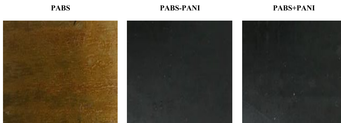
Figura 45 - Painel de aço carbono com aplicação dos látices: PABS, PABS-PANI e PABS+PANI
