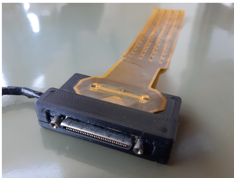
Figura 91 – Adaptador conectado à matriz de eletrodos.
