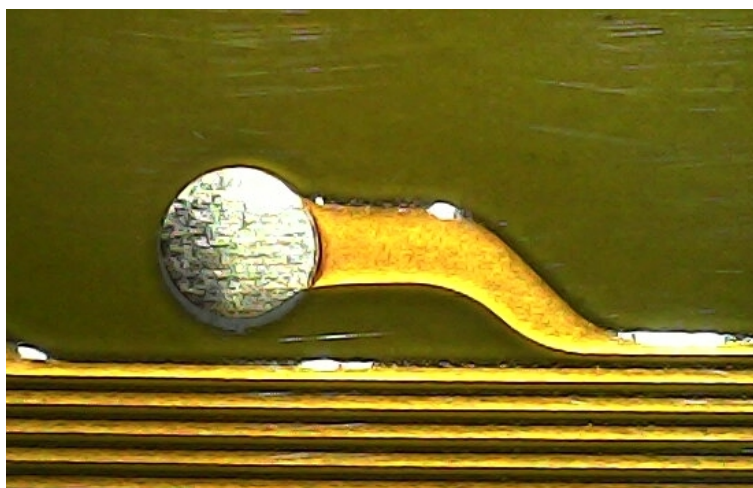
Figura 90 – Detalhe de um dos contatos da matriz de eletrodos, exibindo a conexão entre o contato e a trilha, com aumento gradativo da espessura da trilha e uso de curvas suaves, de forma a evitar pontos de esforço mecânico.
