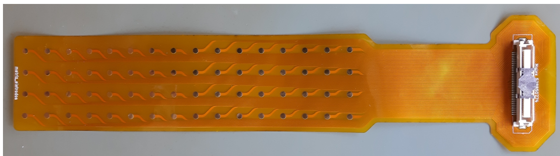
Figura 89 – Matriz de eletrodos de 16 linhas por 4 colunas, com 8mm de espaçamento entre eletrodos e contatos com 2mm de diâmetro.
