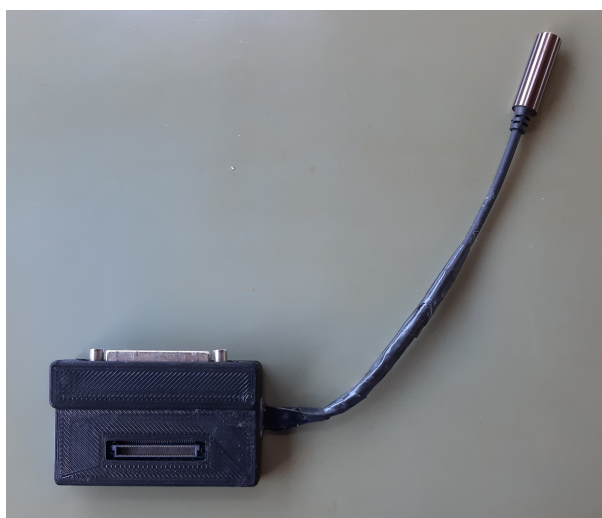
Figura 88 – Aspecto final do adaptador para conexão da matriz de eletrodos e célula de carga.
