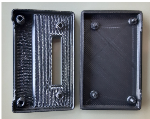
Figura 87 – Vistas interiores da tampa superior (à esquerda) e inferior (à direita) da caixa adaptadora.
