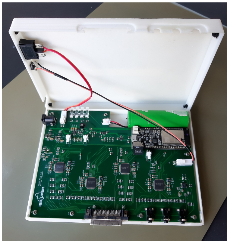
Figura 80 – Caixa principal aberta, com a placa principal posicionada em seu interior.
