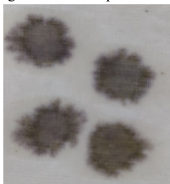
Figura 22 - Gotas de reagente iodeto de potássio com tratamento oxidativo
