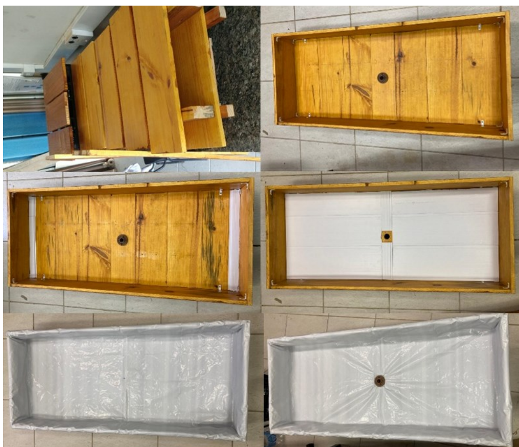
Figura 24 - Montagem da estrutura do lisímetro
