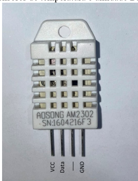
Figura 15 – Sensores de temperatura e umidade DHT22/AM2302
