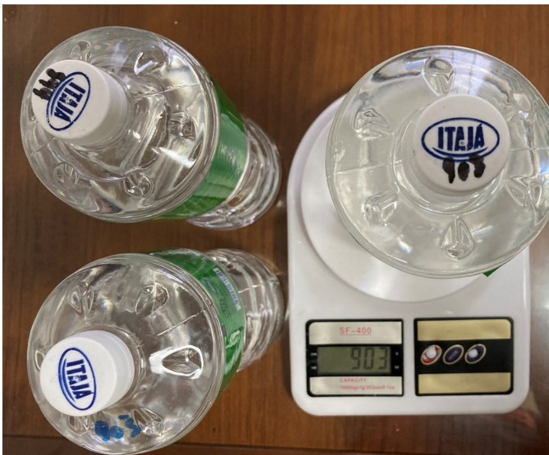
Figura 22 – Obtenção de objetos com pesos conhecidos para a calibração
