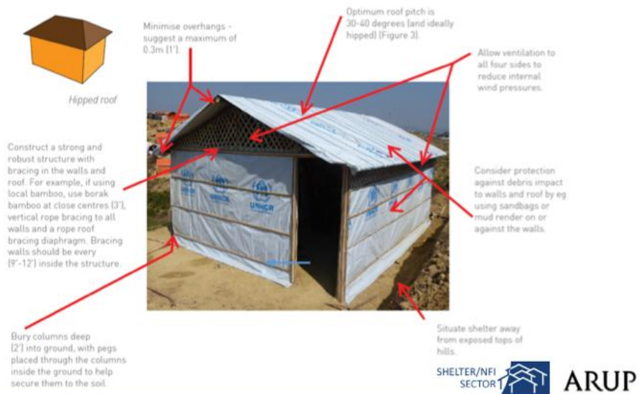
Figura 45: Imagem com 7 orientações para construção de abrigo de bambu resistente ao vento. Fonte: Shelter/NFI Sector Cox's Bazar; ARUP (2018)
