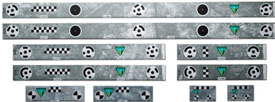
Figura 20 – Escalas fotogramétricas utilizando alvos.
