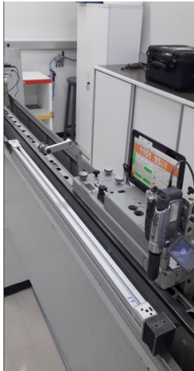
Figura 67 – Ensaio com interferômetro para medir a distância entre os alvos fotogramétricos na escala 1.
