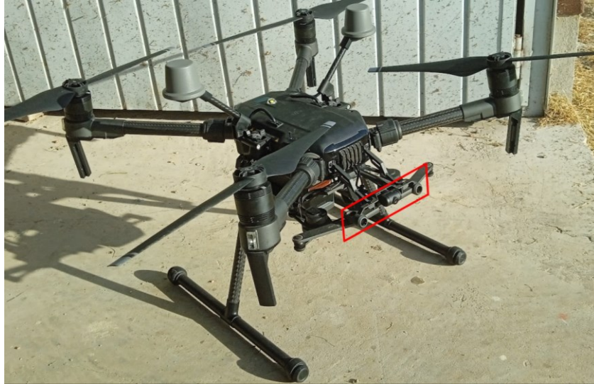
Figura 38 – Aeronave DJI Matrice 210 V2 RTK, em destaque o sistema de visão estéreo frontal para detecção e desvio de objetos.
