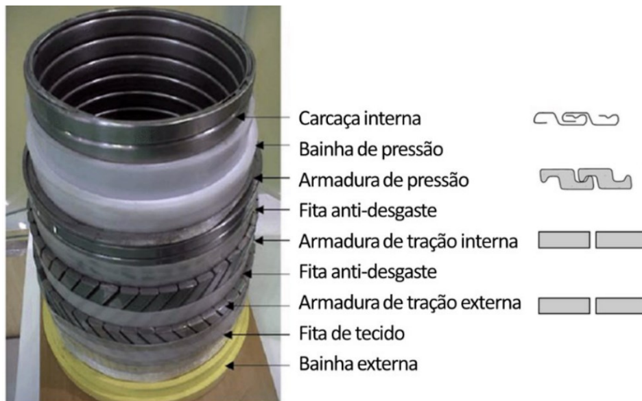
Figura 6 – Estrutura detalhada dos dutos flexíveis utilizado para extração de petróleo offshore .
