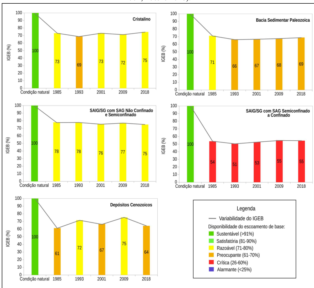
Figura 72 – Aplicação do IGEB para estimativa da disponibilidade do escoamento de base nas bacias hidrográficas representativas dos domínios hidrogeológicos do Estado de Santa Catarina para os cenários de condição natural simulada e cenários observados (1985, 1993, 2001, 2009 e 2018).
