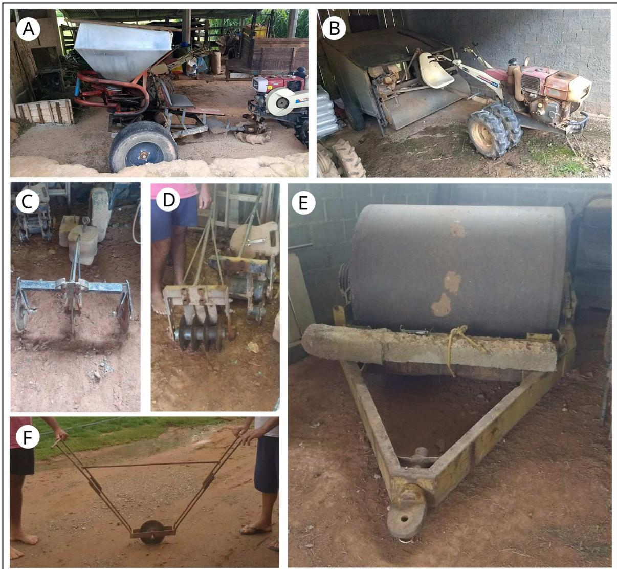
A - espalhador de ureia; B - juntador de palha após a roçagem da grama; C - conjunto de discos de corte para colheita da grama; D - conjunto de discos de corte da grama em filetes; E - rolo para compactação da grama e equipamento de uso manual; F - disco de corte da grama. Fonte: Acervo da autora com fotografias nas propriedades das famílias entrevistadas.
