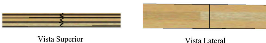
Figura 1 – Viga em LVL com emenda dentada.
