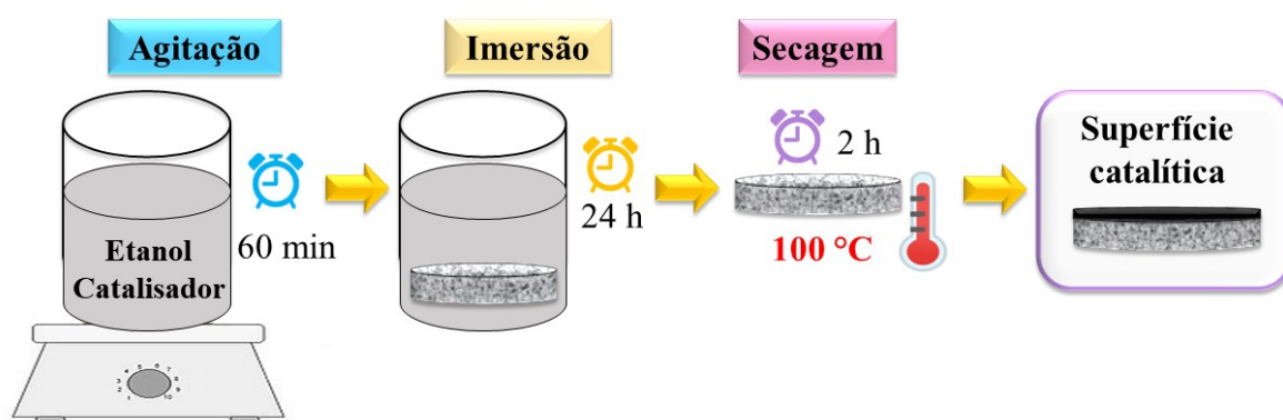
Figura 5.2 - Diagrama esquemático do método de impregnação das membranas de PTFE e PVDF com os catalisadores \text{Fe}_3\text{O}_4 e \text{Fe}_2\text{O}_3 .
