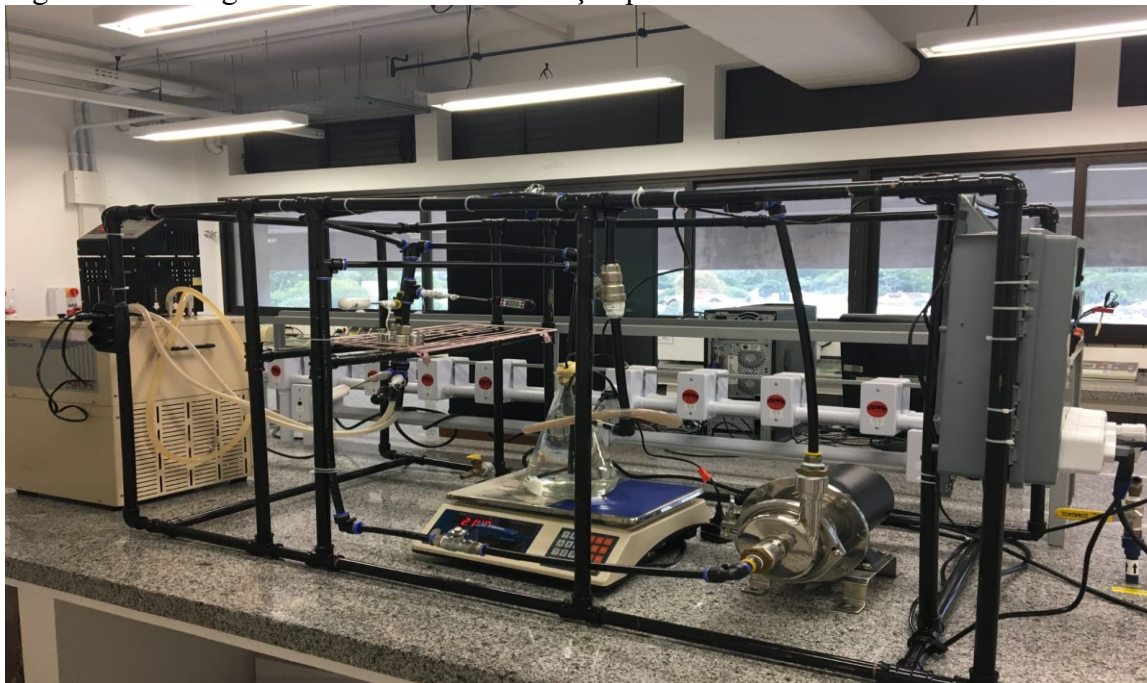
Figura D-1. Fotografia da unidade de destilação por membranas utilizada.
