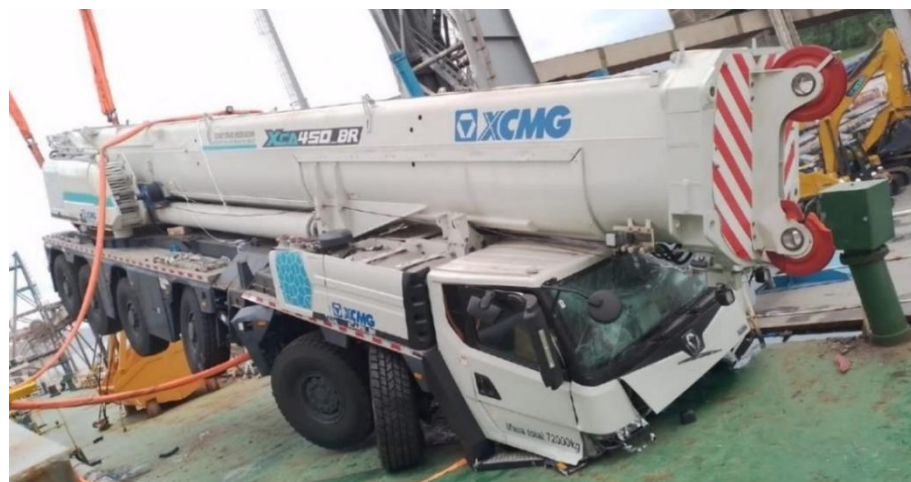
Figura 65: Acidente com caminhão após as alças que o seguravam arrebentaram.
