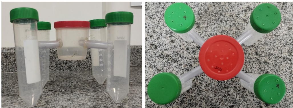
Figura 8 - Câmaras em X utilizadas no teste de repelência
