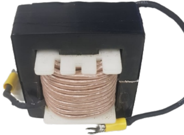
Figura 3.14 – Indutor projetado para cada módulo do conversor cc-cc Buck .
