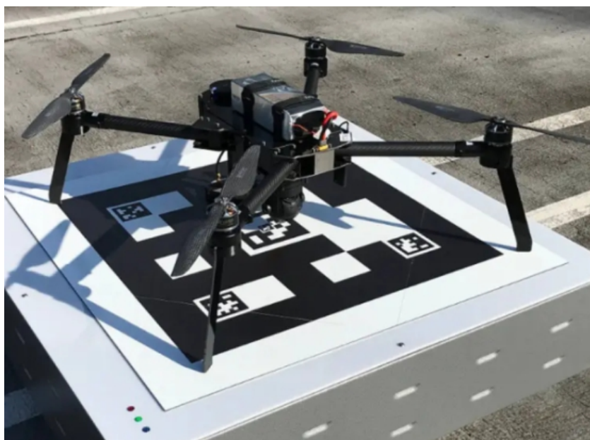
Figura 2.11 – Plataforma de carregamento para baterias de aeronaves remotamente pilotadas.
