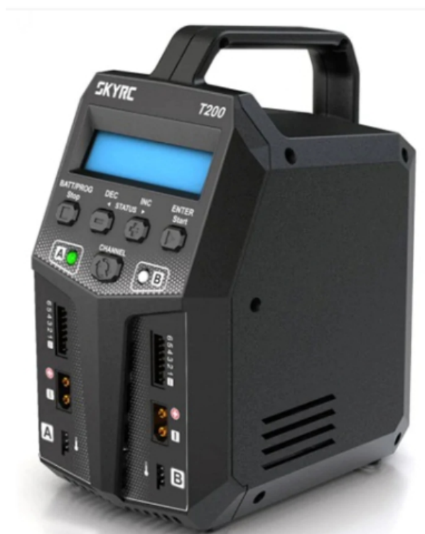
Figura 2.10 – Carregador portátil para baterias com até seis células em série (6S).
