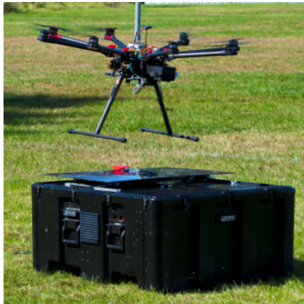
Figura 2.1 – Estação de recarga/substituição.
