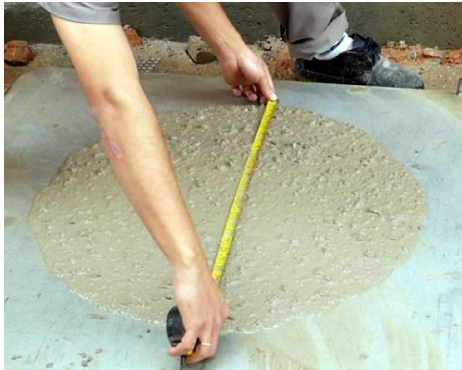
08 Recebimento do concreto – Confira o documento de entrega e o lacre da bica de descarga (antes de ser rompido) e recuse o concreto se houver discordância. Verifique, antes do lançamento, se o concreto tem a consistência desejada e se não ultrapassou o abatimento ou o espalhamento especificados.
