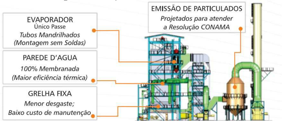
Figura 4.1 – Esquema da Caldeira modelo AT
