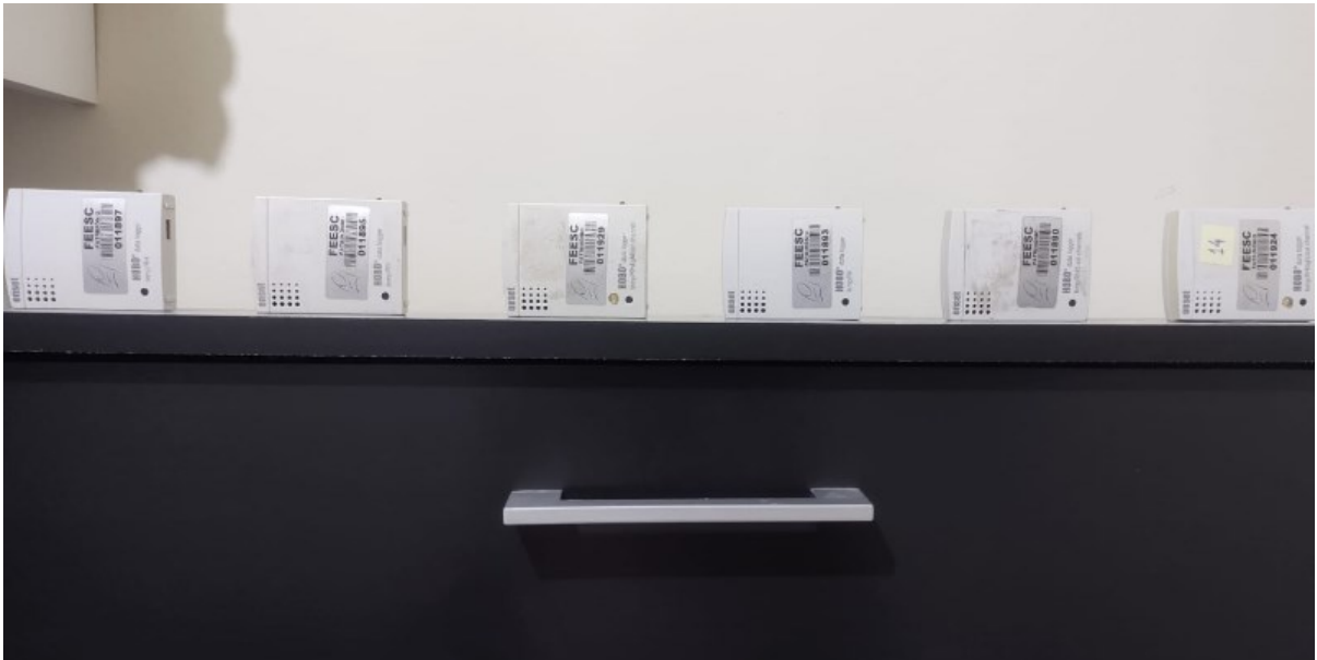
Figura 22 - Distribuição dos registradores de temperatura para análise de calibração
