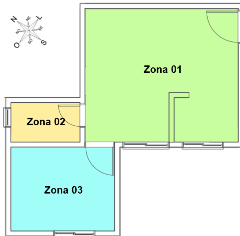
Figura 25 - Zonas térmicas do apartamento 502 do bloco 01
