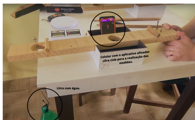
Figura 40 – Exemplo de como realizar a medida usando a Tensão na corda.
