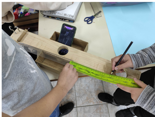
Figura 39 – Exemplo de medidas da frequência em função do comprimento da corda usando o instrumento arcaico.
