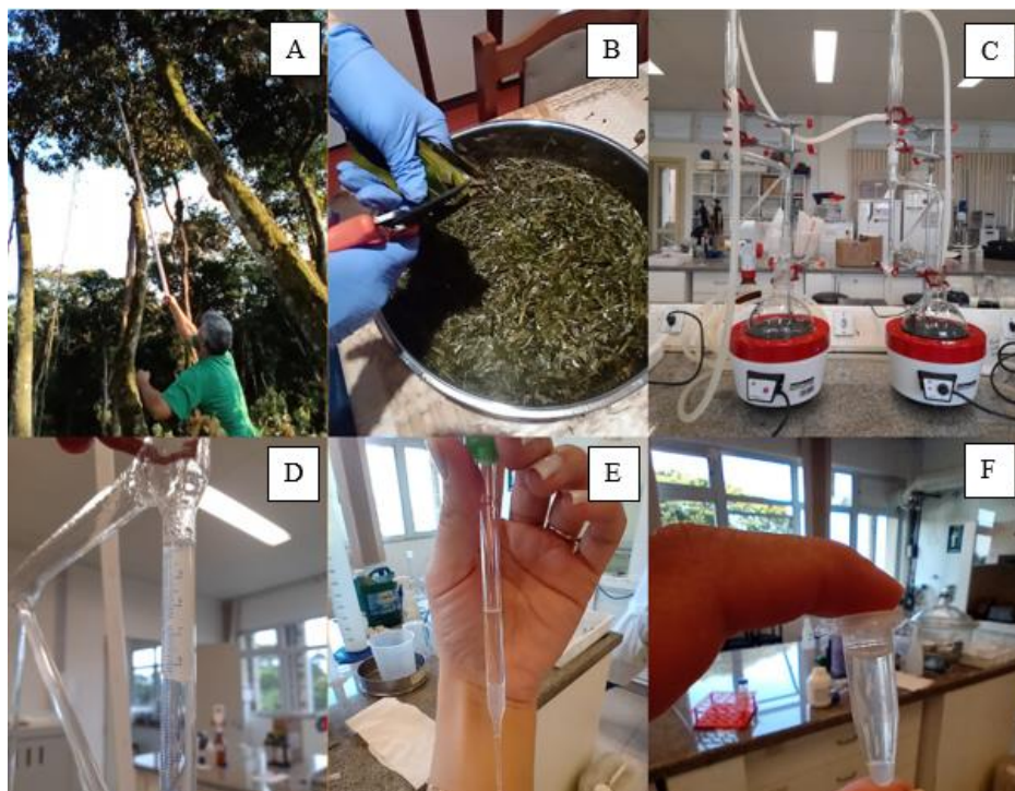
Figura 12 – Etapas do processo de extração de óleo essencial, onde A: coleta das folhas com o auxílio de um podão; B: picagem das folhas; C: extração de óleo essencial no aparato de Clevenger modificado; D: volume de óleo essencial extraído; E: separação do óleo essencial da água com a pipeta de Pasteur; F: óleo essencial livre de água no Eppendorf.
