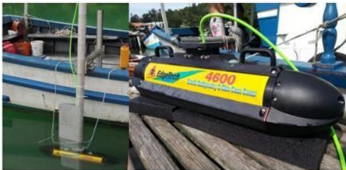
Figura 4. À direita interferômetro Edgetech 4600 e a esquerda equipamento instalado na embarcação.
