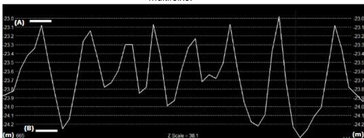
Figura 9. Mensuração da altura da feição extraído de um perfil batimétrico multifeixe.
