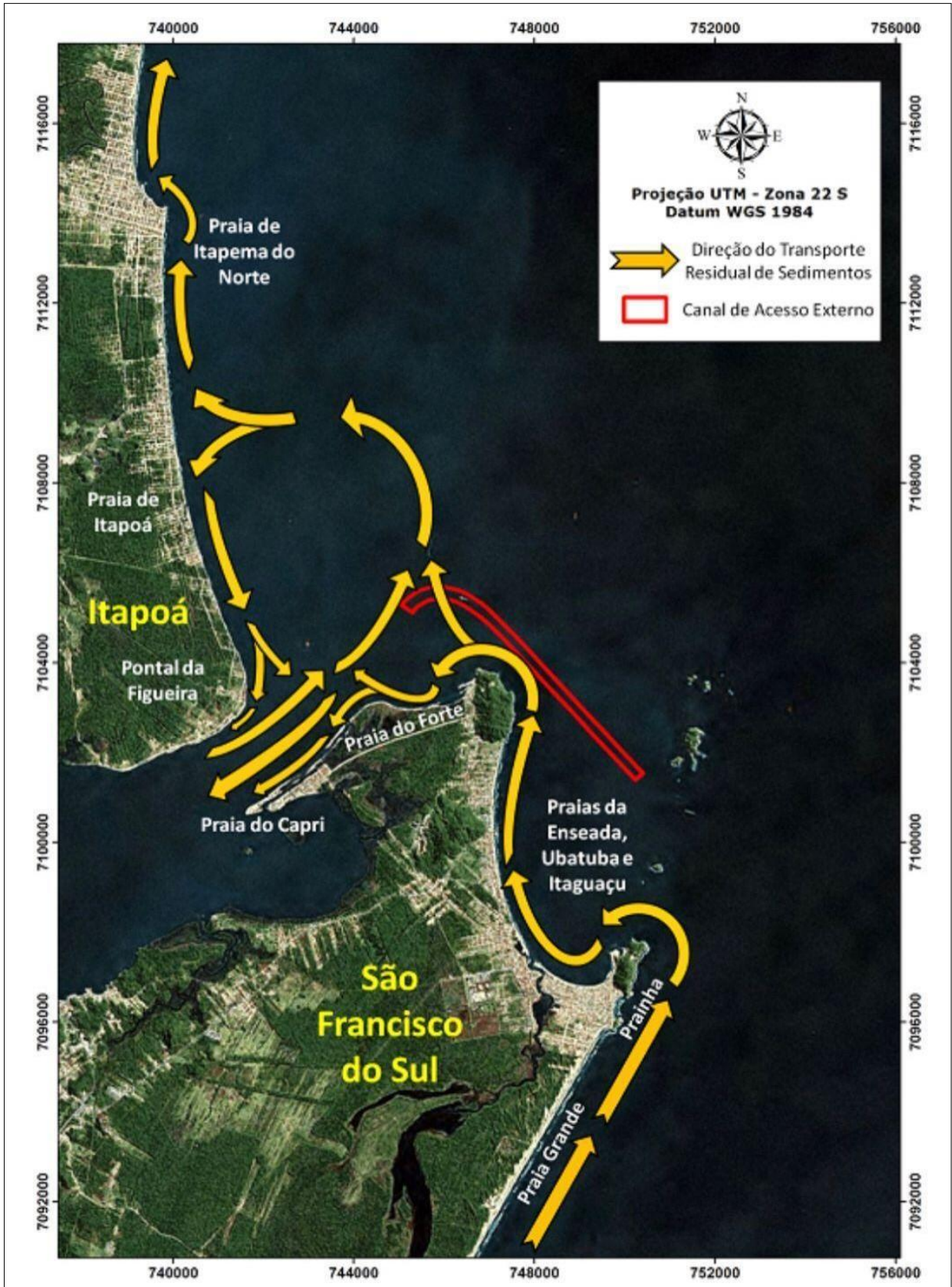
Figura 1. Modelo conceitual da dinâmica sedimentar na região da desembocadura da baía da Babitonga. O tamanho e a largura da seta não representam a magnitude do transporte de sedimentos, apenas a direção.
