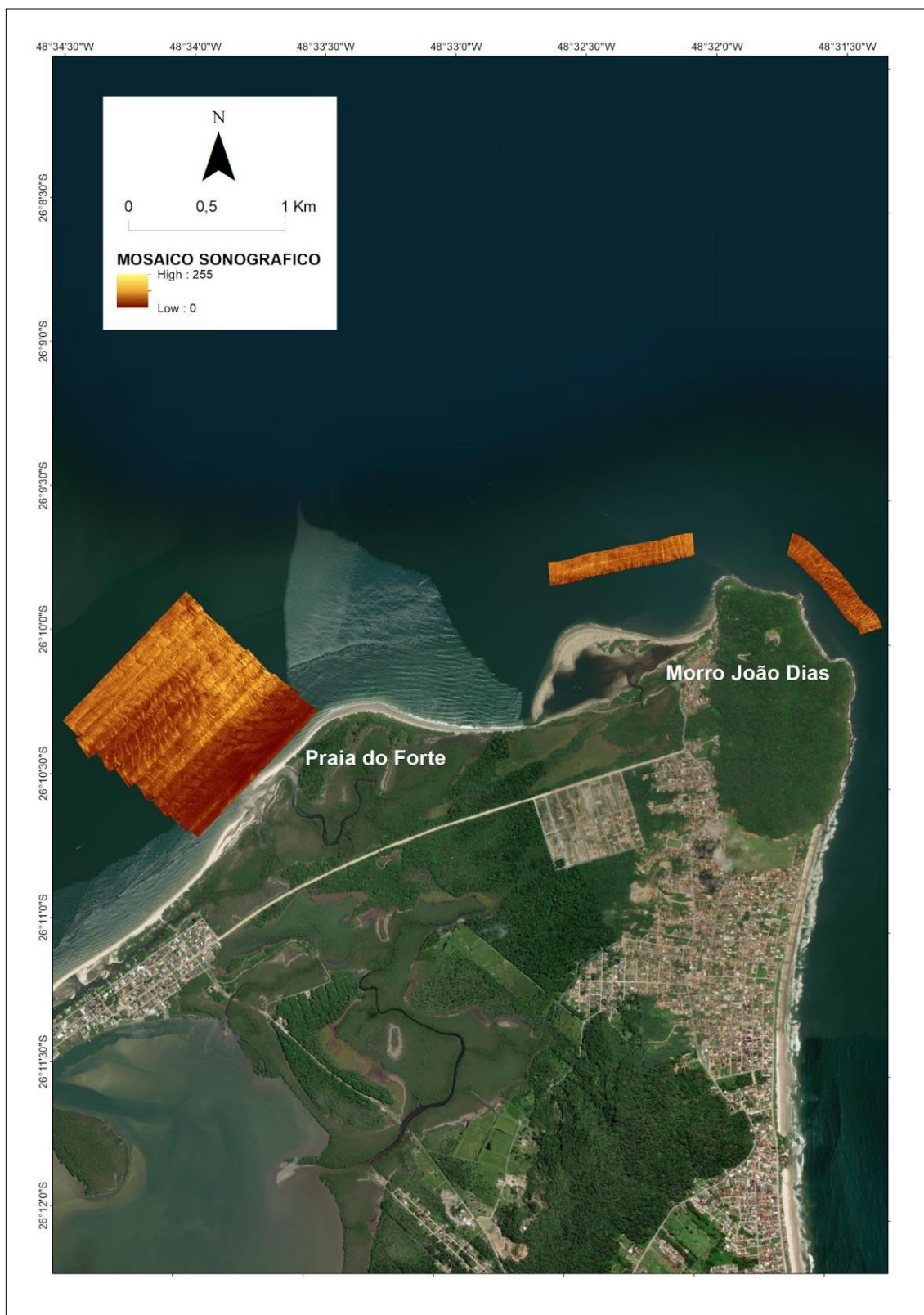
Figura 15. Mapa sonográfico obtido a partir do levantamento de sonografia.
