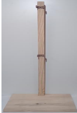
Figura 7: Montagem da base com os anéis de sustentação
