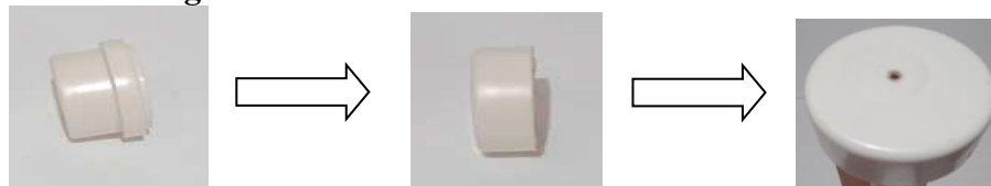
Figura 5: Fechamento do tubo de deslizamento
