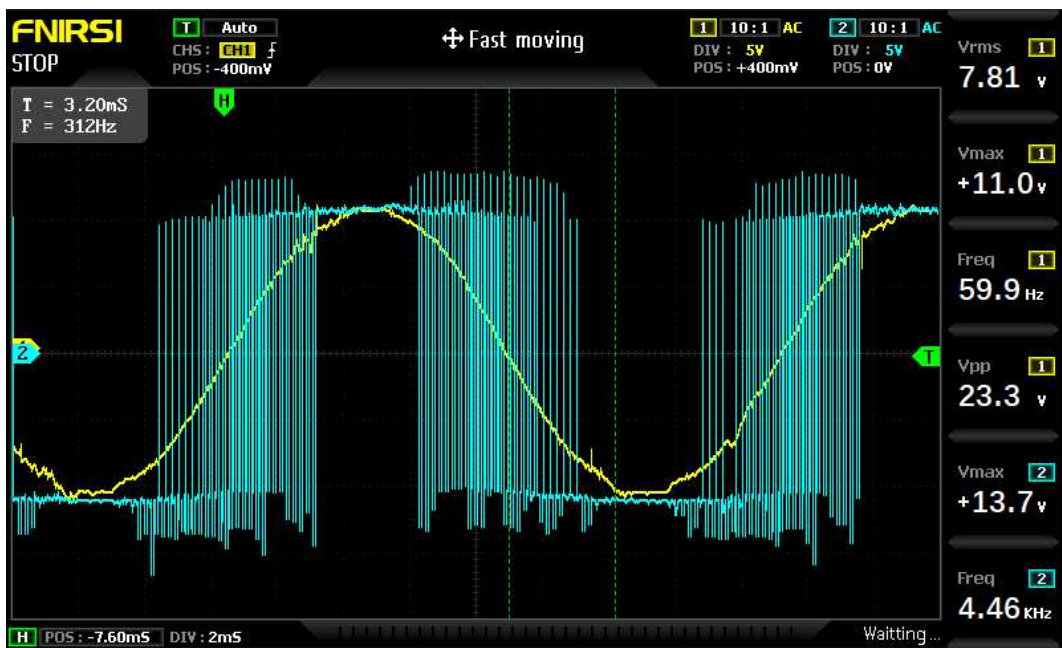
Figura 51 – Inversor sendo operado com senoide de 60Hz. Tensão medida na saída do inversor e sob o capacitor do filtro utilizado
