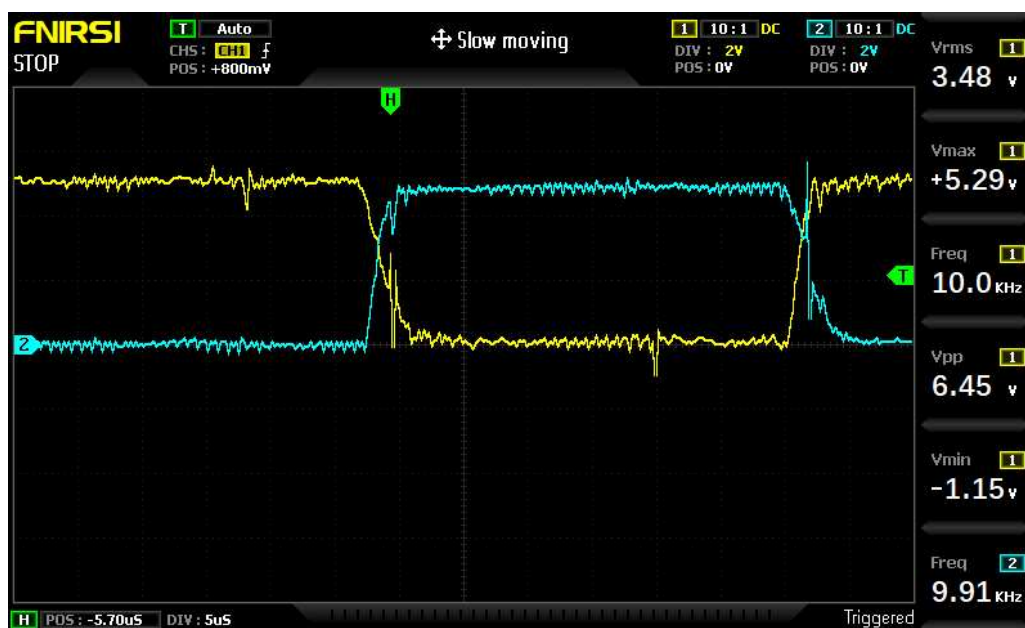
Figura 49 – Zoom aplicado no sinal PWM e seu sinal negado gerados pelos módulo de controle
