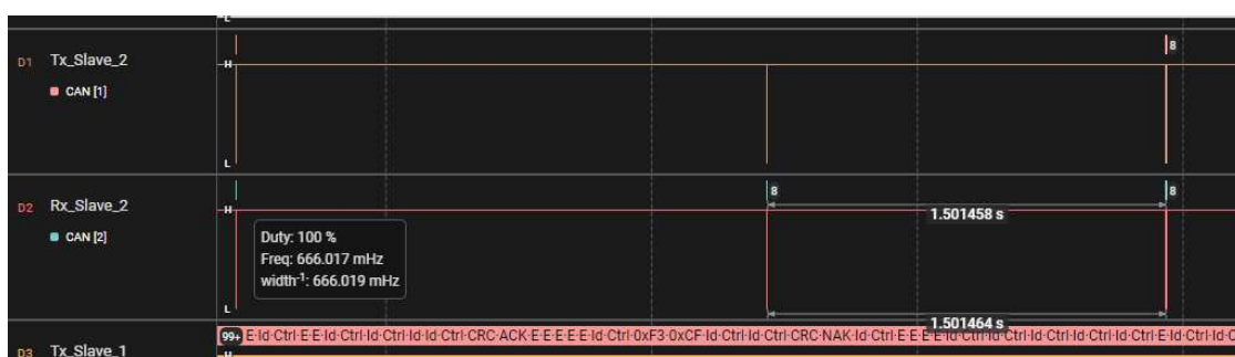
Figura 56 – Intervalo de 1,5s entre o inversor slave receber a mensagem do inversor master e responder.
