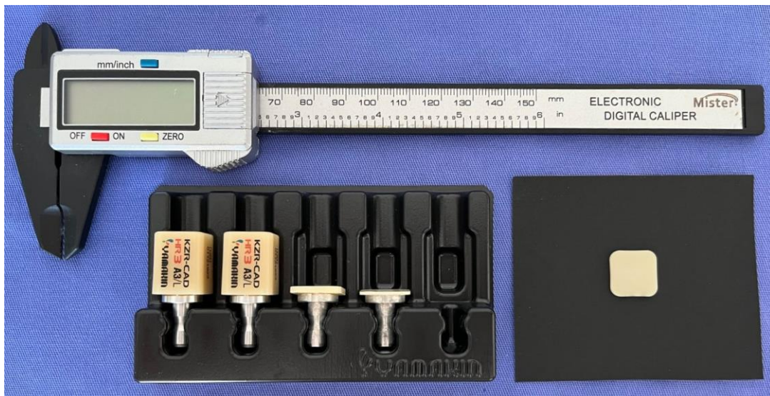
Figura 3 - Acabamento das amostras com papel de óxido de alumínio (600~1200) e conferência da espessura com paquímetro digital.
