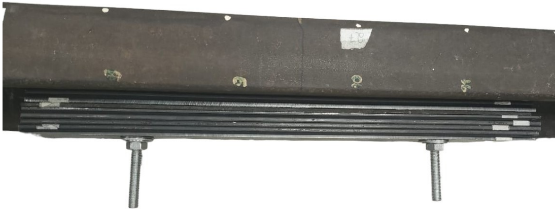
Figura 27 – Construção de um atenuador genérico no trilho
