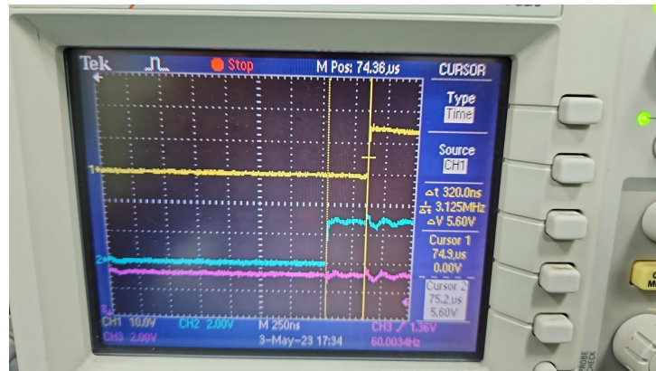
Figura 33 – Medição da diferença de tempo entre sinais de subida das portas lógicas do microcontrolador e de um gate-driver
