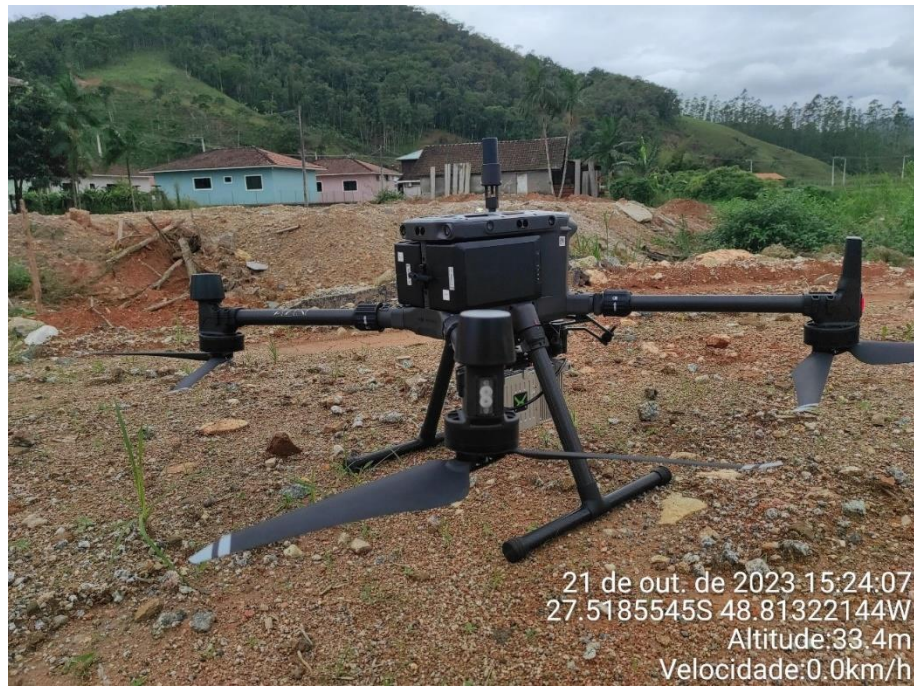
Figura 10 – Instalação na estaca 0+0 da Plataforma Matrice 300 com Lidar XMAP LS 100
