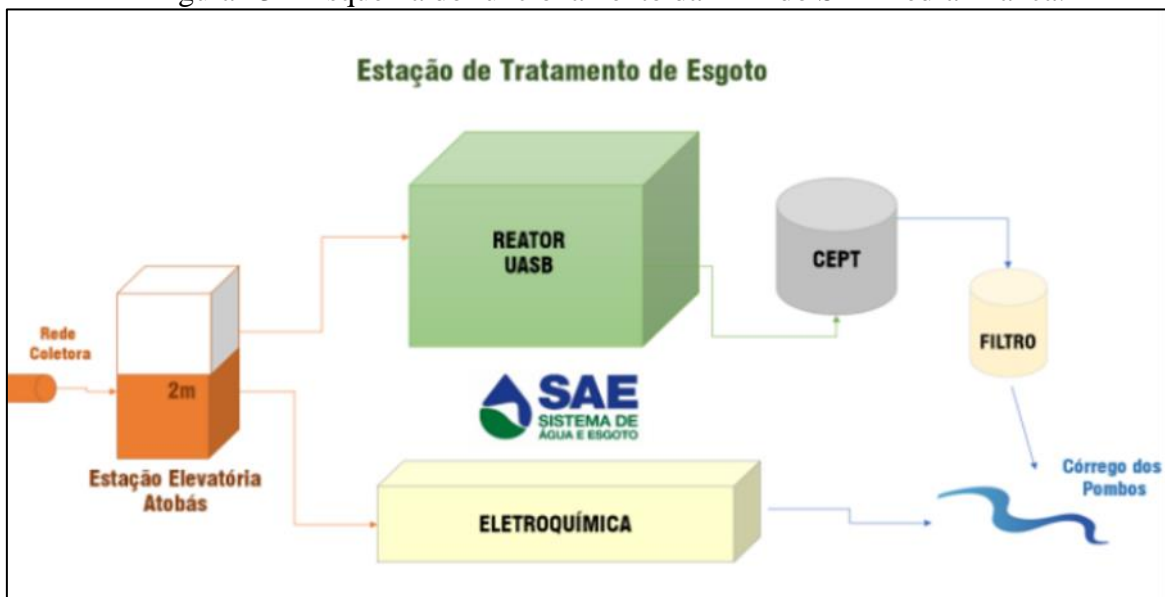
Figura 23 – Esquema do funcionamento da ETE do SAE Pedra Branca.
