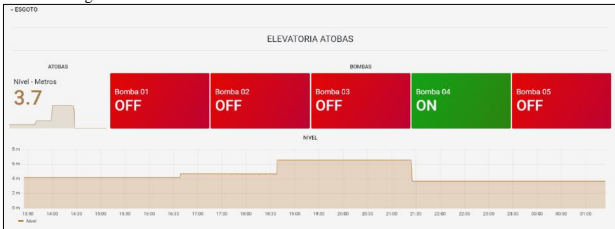
Figura 22 – Sistema de telemetria com os dados de nível da EEE Atobás.
