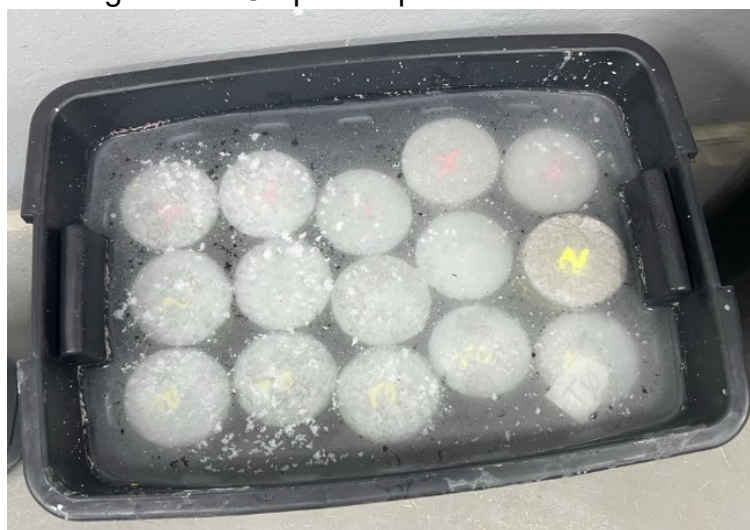
Figura 11 - Corpos de prova na cura úmida
