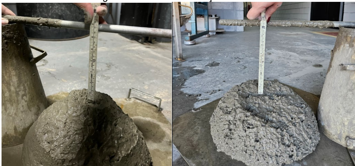
Figura 21 - Abatimento traços T0 e T25
