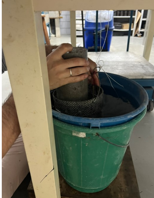
Figura 17 - Corpo de prova sendo imerso em água
