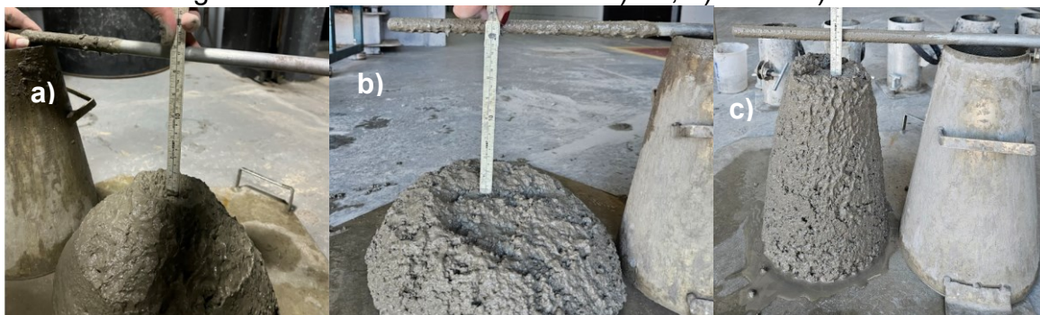
Figura 14 - Ensaio de abatimento a) T0, b) T25 e c) T50
