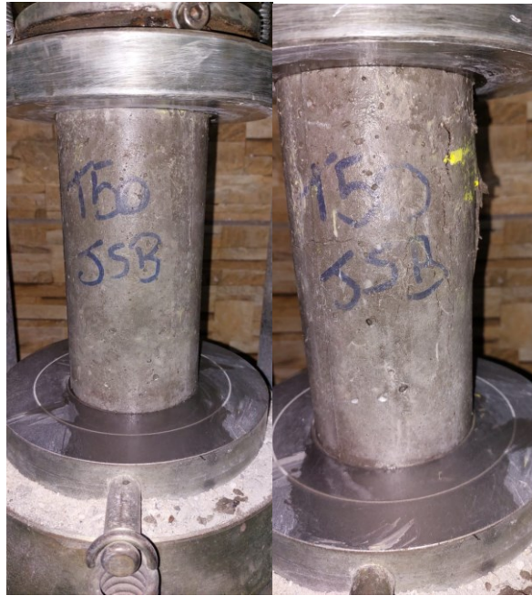
Figura 16 - Ensaio de compressão T50
