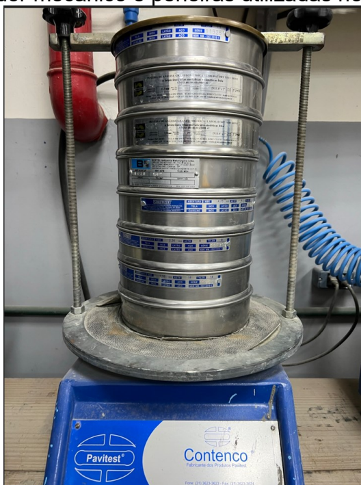
Figura 12 - Agitador mecânico e peneiras utilizadas no agregado graúdo
