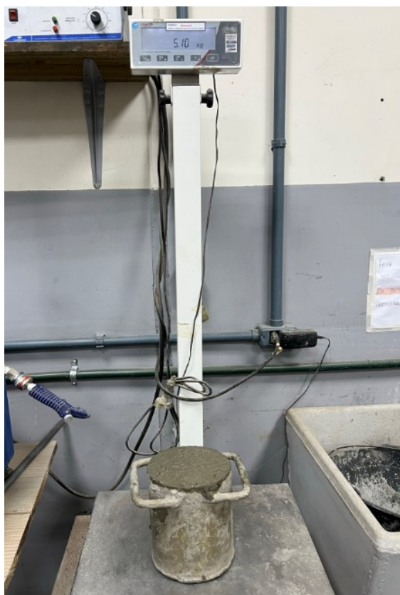
Figura 15 - Pesagem da massa do T0
