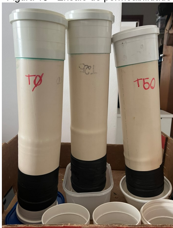
Figura 18 - Ensaio de permeabilidade
