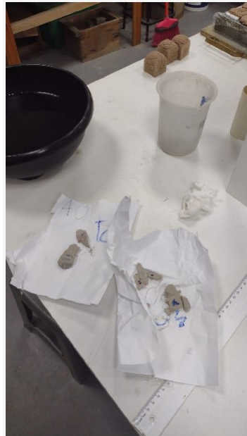
Figura 9: Amostras dos CPs resfriando ao ar livre após permanência na estufa por 72h
