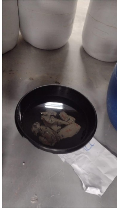
Figura 11 - Imersão das amostras por 72h
