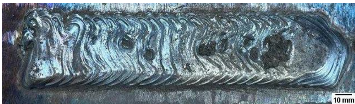
Figura 19. Cordão de Referência com V_a de 3,6 m/min.
