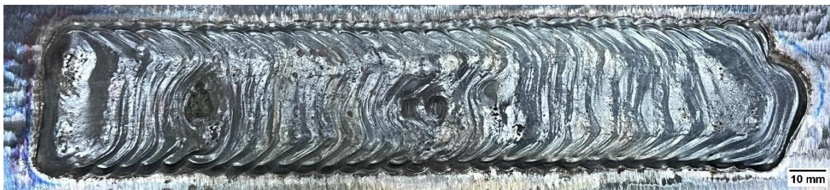
Figura 21. Cordão de solda com V_a de 4,5 m/min e corrente de indução de 60 A.
