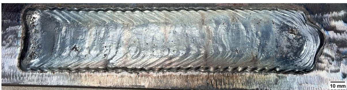
Figura 22. Cordão de solda de referência com V_a de 5,5 m/min.
