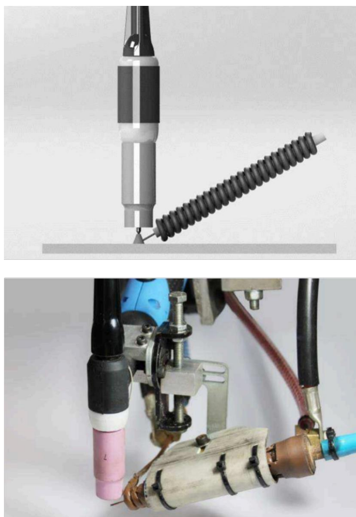
Figura 11. Conceito e dispositivo construído para aplicação da técnica IHW – TIG.
