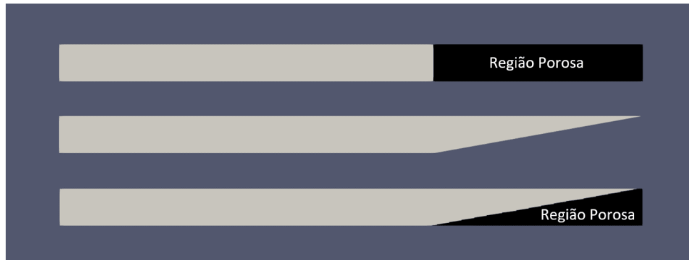
Figura 11 – Esquemático das Três Estratégias Consideradas para Absorção Passiva, sendo o domínio formado pelas regiões brancas e pretas
