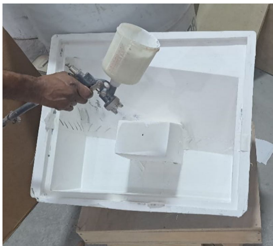
Figura 7 – Aplicação do gelcoat com pistola de pintura.
