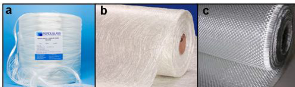
Figura 3 – Diferentes tipos de reforços encontrados no mercado (a) Roving, (b) Manta e (c) Tecido.
