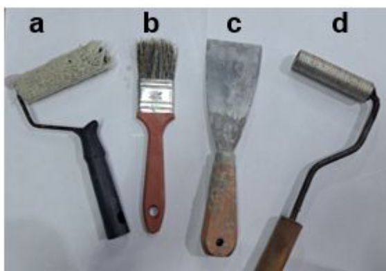
Figura 16 – Principais ferramentas utilizadas no processo de laminação manual (a) Rolo de lã de carneiro, (b) Trincha, (c) Espátula e (d) Rolete.
