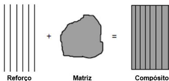
Figura 2 - Fases constituintes do material compósito.
