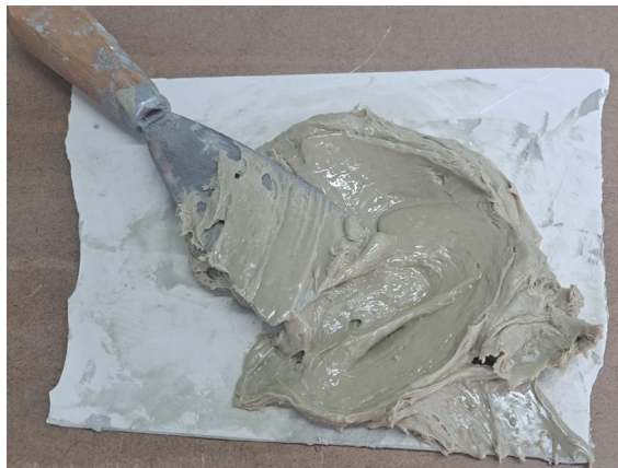
Figura 18 – Massa poliéster com fibra moída.
