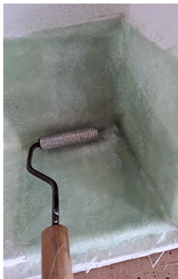
Figura 22 – Compactação da laminação com rolete.
