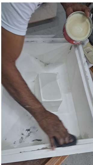
Figura 20 – Aplicação da cera desmoldante.
