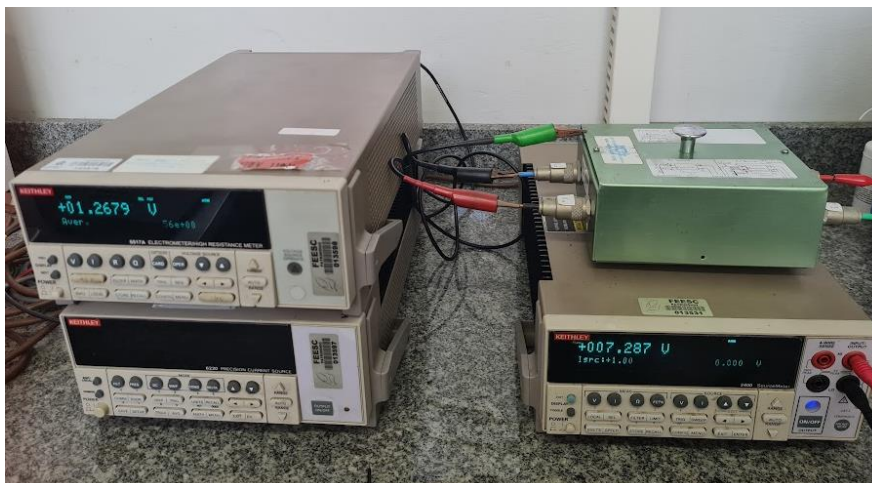
Figura 11 – Equipamentos utilizados para determinação da condutividade elétrica pelo método de 4 pontas.
