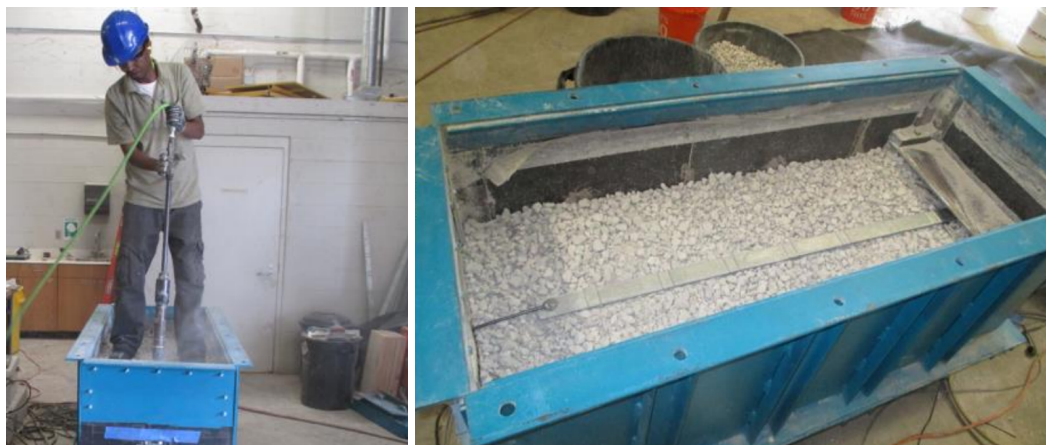
Figura 2.10 - Ensaio de arrancamento para reforços metálicos.
