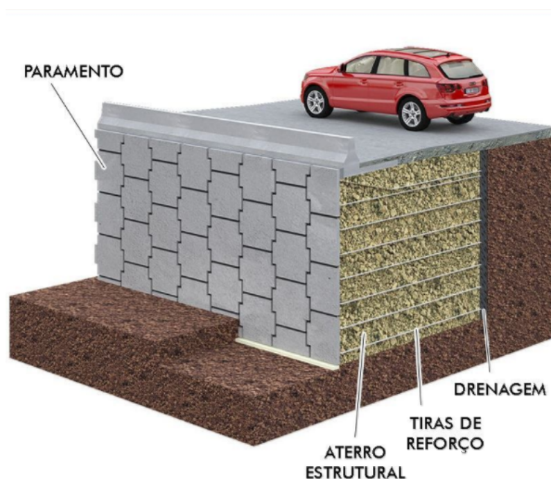
Figura 2.6 - Seção transversal do sistema Terra Armada.
