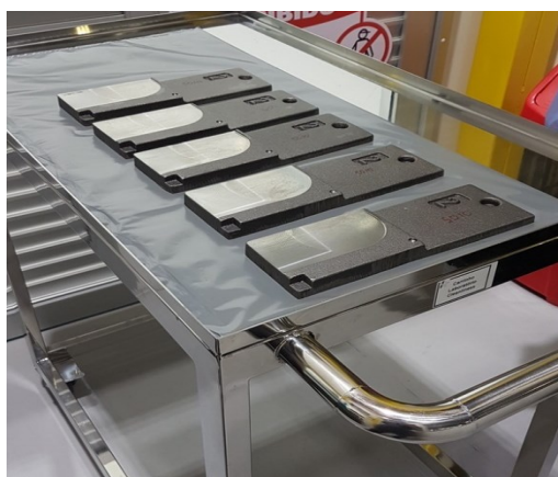
Figura 20 – Imagem ilustrativa dos corpos de prova sendo transportados para o laboratório de análise cleanliness
