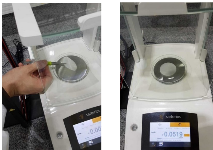
Figura 24 – Posicionamento da membrana sobre a balança de precisão para análise gravimétrica.
