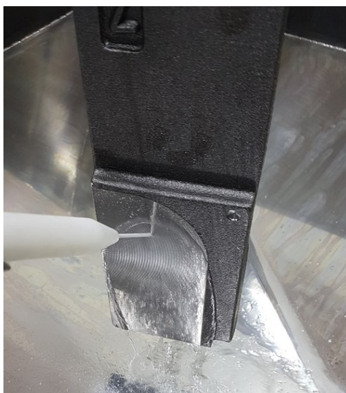
Figura 23 – Enxágue sob pressão sendo realizado na superfície usinada do corpo de prova
