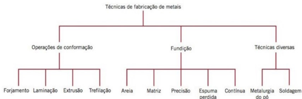
Figura 4 - Classificação das técnicas de fabricação de metais.
