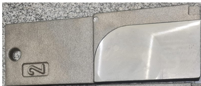
Figura 18 – Imagem ilustrativa do corpo de prova utilizado nos testes, evidenciando a área usinada
