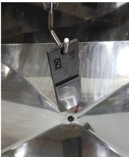
Figura 22 – Corpo de prova disposto na câmara de extração.
