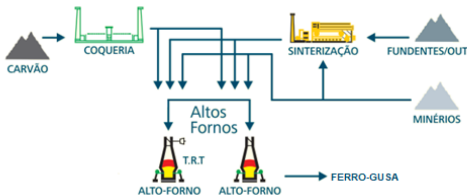
Figura 5 - Diagrama simplificado da obtenção de ferro-gusa
