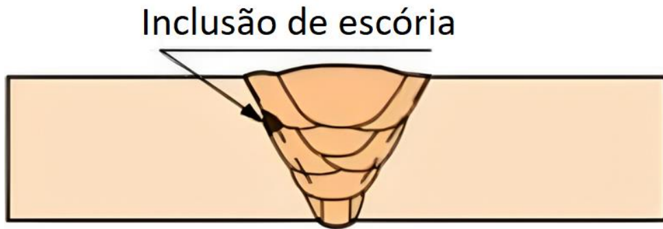
Figura 14 - Ilustração do defeito de inclusão de escória.
