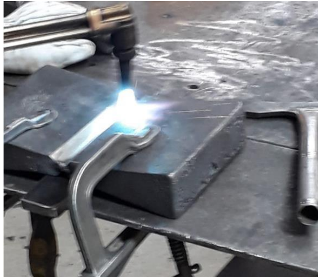
Figura 25- Pré-aquecimento da junta de solda com maçarico.
