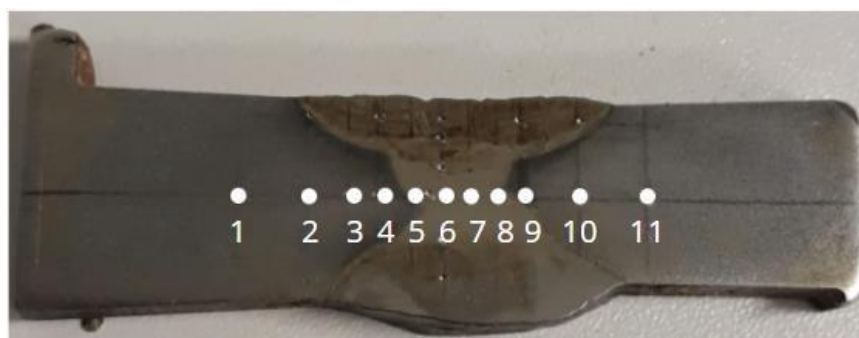
Figura 44 - Pontos de medição de dureza para amostra de nodular com E-NiCi + E7018.
