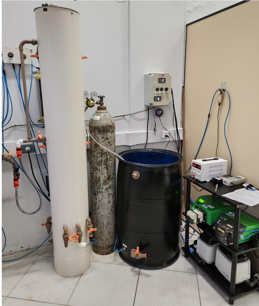
Figura 7: Sistema do reator UASB.
