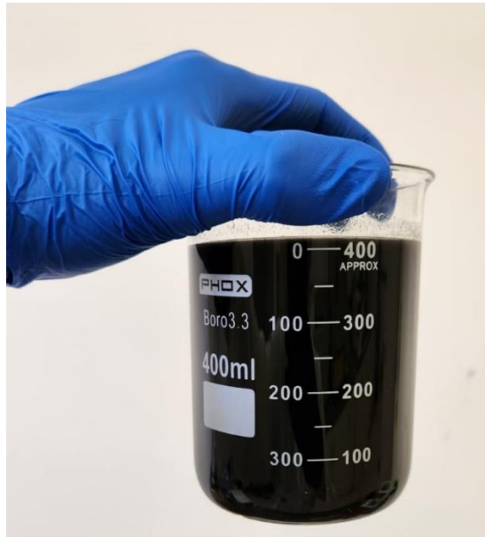
Figura 13: Lodo do fundo do UASB utilizado como inóculo.
