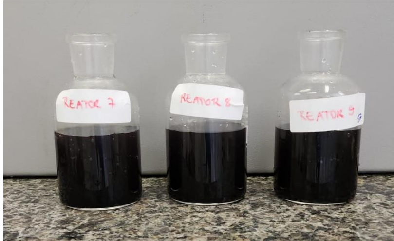
Figura 14: Frascos reatores com a mistura de substrato e inóculo do teste 1.
