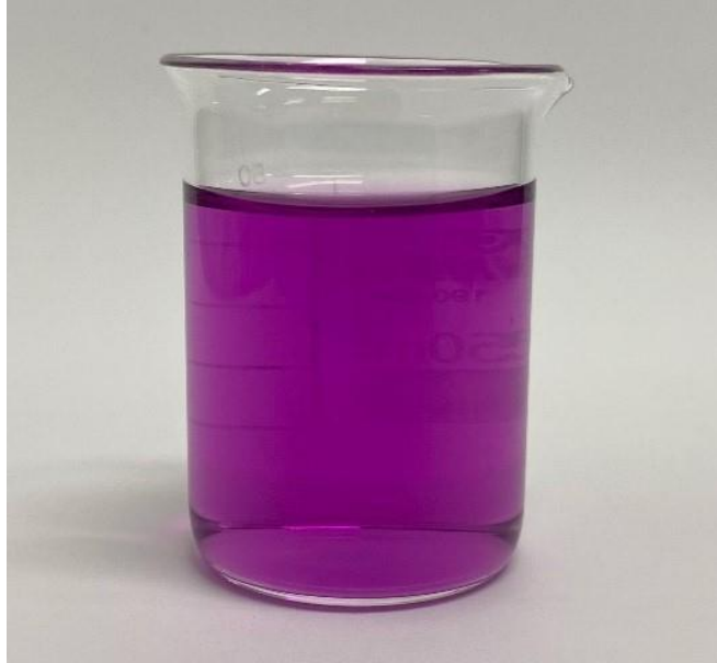
Figura 8: Efluente têxtil sintético produzido e utilizado no trabalho.
