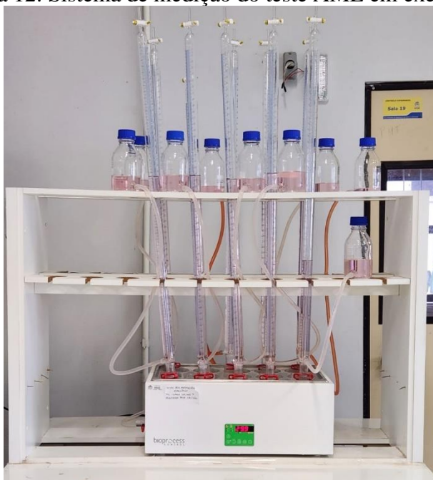
Figura 12: Sistema de medição do teste AME em execução.
