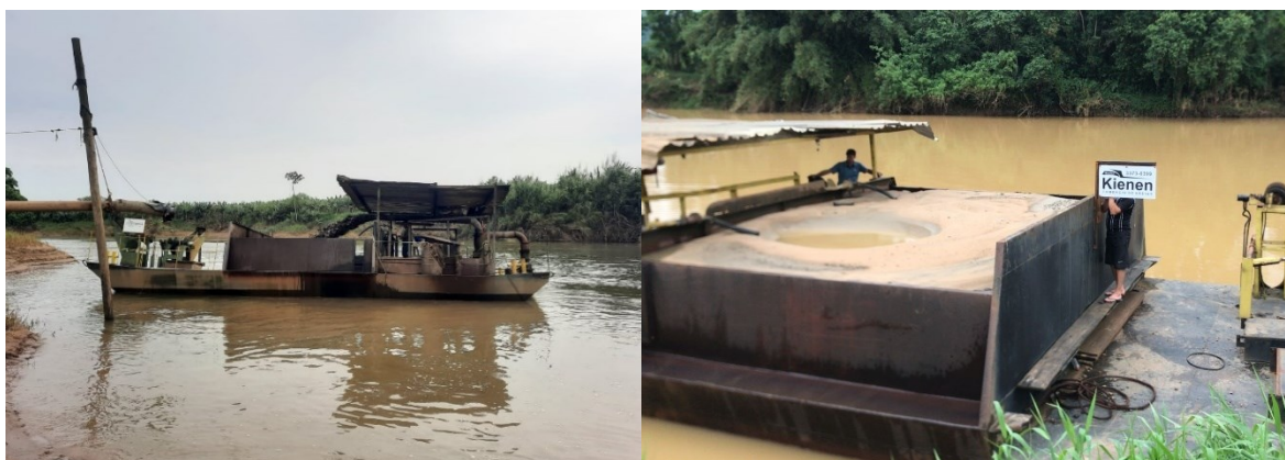
Figura 1 - Processo de dragagem. A esquerda sucção de areia do leito para dentro da draga. A direita balsa carregada. Fonte: a autora.
