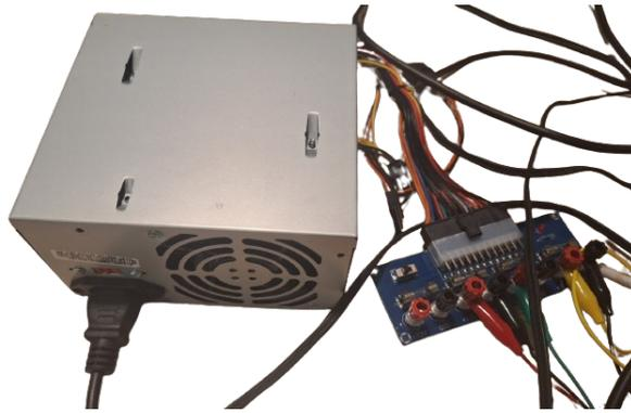
Figura 23 – Fonte ATX de 200W. Fonte: Autor, 2023
