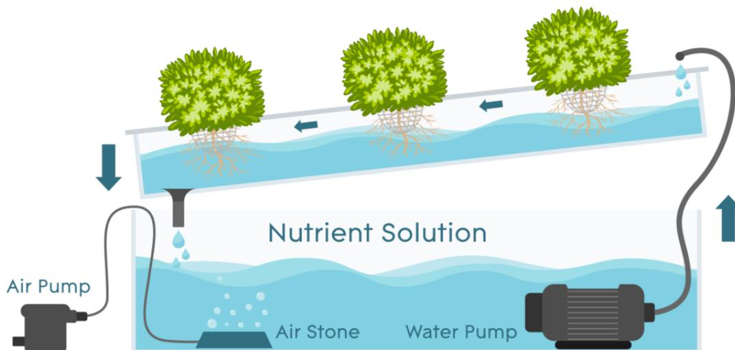
Figura 4 – Representação do sistema NFT. Fonte: AGrowTonics, 2021
