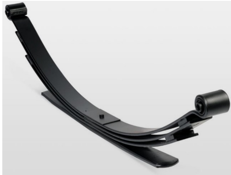
Figura 8 - Arranjo de feixe de lâminas de ação progressiva
