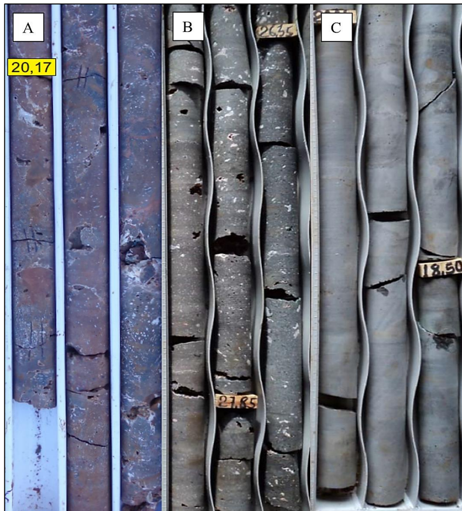
Figura 4-4. Testemunhos de sondagem com principais litotipos encontrados no local da barragem: a) brecha basáltica b) basalto vesicular amigdaloidal c) basalto denso
