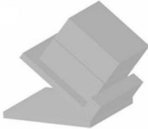
Figura 6. Ensaio de inclinação utilizando dois blocos sobrepostos para estimar \phi_b .
