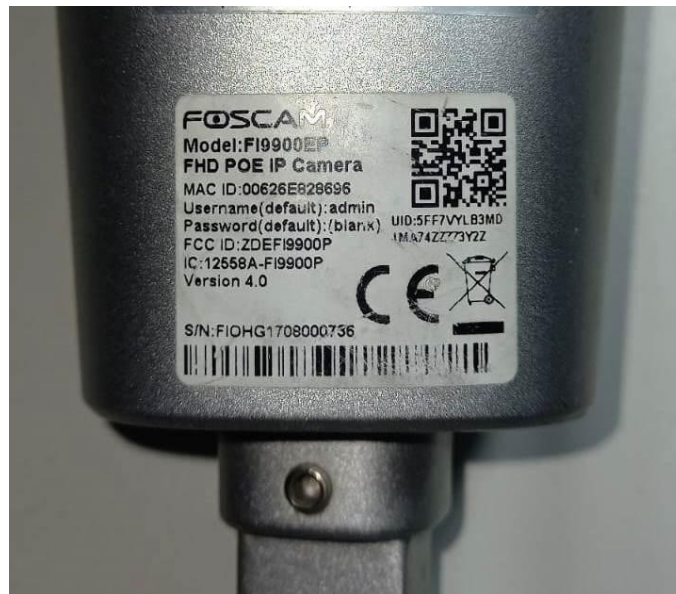
Figura 9 - Etiqueta com credenciais padrão de fábrica.
