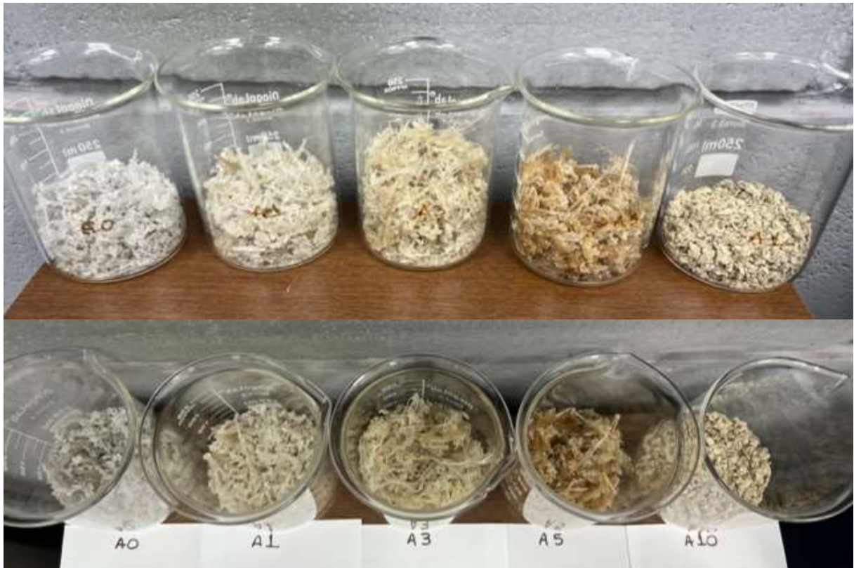
Figura 5 – Amostras preparadas para a pesquisa após o processo com formão de vanádio
