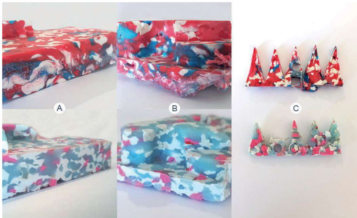
Figura 7: Testes de lixamento (A), corte com serra (B), e corte a laser (C). Fonte: elaborado pelos autores.
