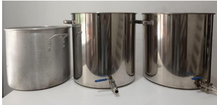
Figura 2 - Panelas de lavagem, mostura e fervura.
