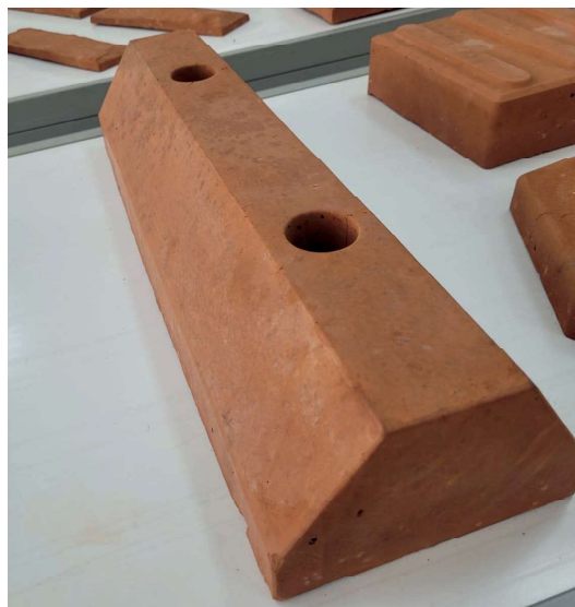
Figura 7: Produto guia “bate-roda” confeccionado com amostras A3.
