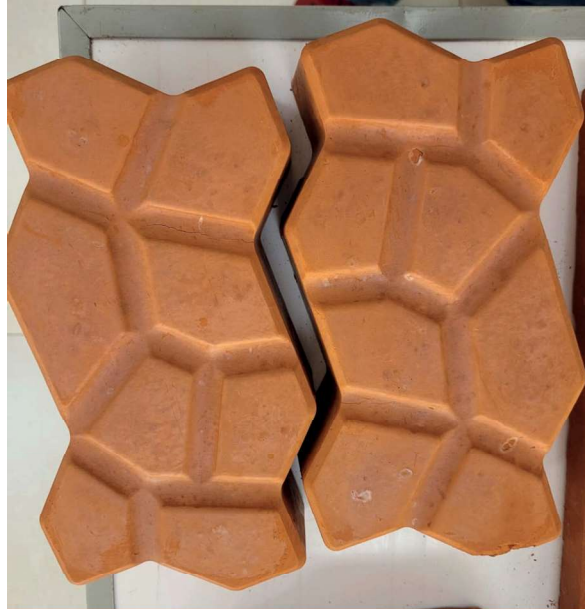
Figura 3: Produto paver intertravado 16 faces trabalhado com amostras A2.
