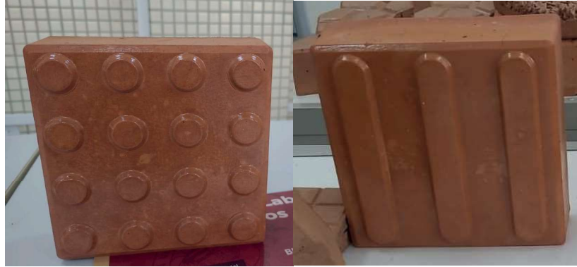
Figura 5: Produtos pisos táteis tipo bola e reto confeccionados com amostras A3.
