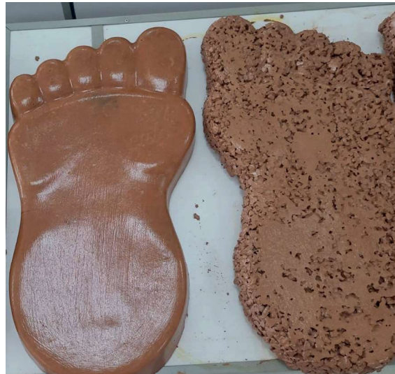
Figura 7: Produto guia “bate-roda” confeccionado com amostras A3.
